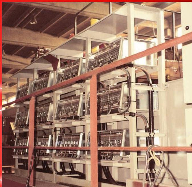
Banco de Resistores trifásicos instalados en una grúa aérea para una planta de fabricación de acero
