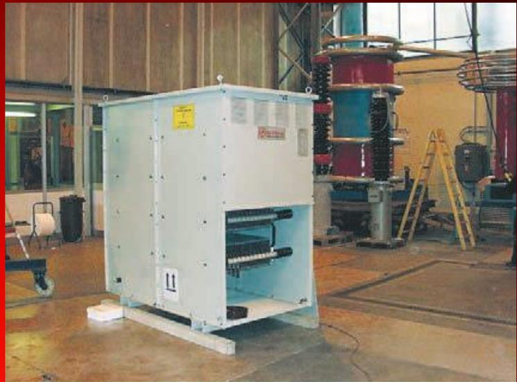
Las resistencias de puesta a tierra **CTTECH S.L. & OZDIRENC** son diseñadas, fabricadas y probadas según la normativa IEEE 32-1972 (Requirements, Terminology and Test Procedure for Neutral Grounding Devices).
